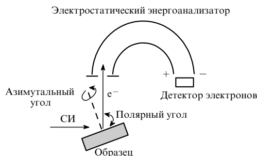
Рис. 15. Схема прибора для съемки фотоэлектронных спектров с угловым разрешением.
